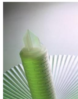
La cartuccia POLIXSTER ADM FREE è ottenuta pieghettando fino a 4 strati di filter media di poliestere a porosità a scalare che consentono di ottenere un grado di filtrazione molto preciso ed una elevata superficie filtrante. L'assemblaggio per sola termosaldatura assicura una struttura compatta e resistente anche a severe condizioni di esercizio.
